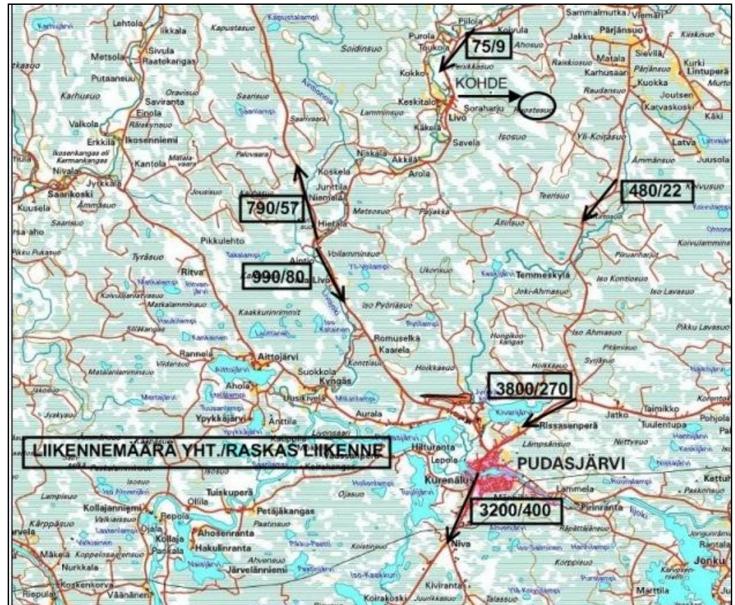
Kuva 5.11 Liikennemäärät ja raskaan liikenteen osuus yleisillä teillä
