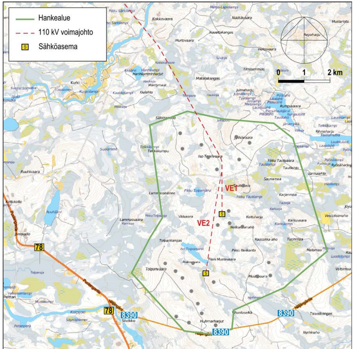
Kuva 3-13. Tolpanvaara-Jylhävaaran tuulivoimapuiston nykyinen tiestö ja alustava voimajohdon linjaus hankevaihtoehtoissa 1 ja 2.
