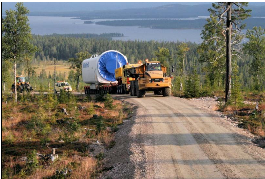
Kuva 3-14. Tuulivoimalaitoksen koneiston kuljetusta. (Kuva: WinWinD, www.winwind.com ).
