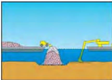
4. Perustusten täyttö, kaapeliojat
