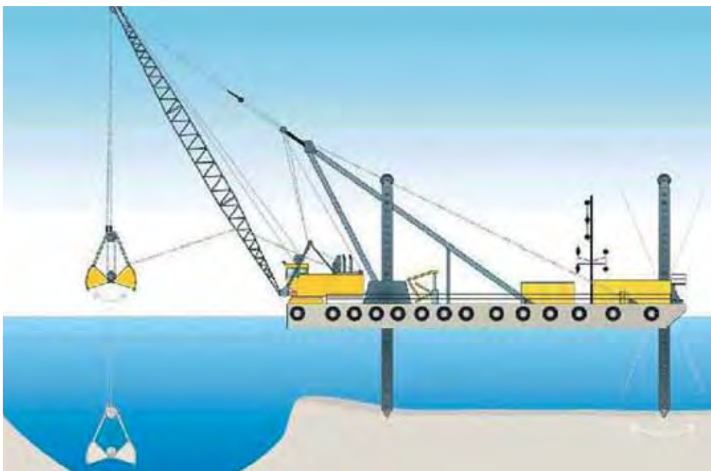
Kuva 4-11. Periaatekuva kahmariruoppaajasta "Meri-Pekka" (Terramare Oy).
