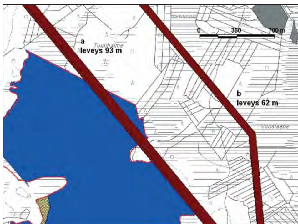
Kuva 7-90. Suunnitellut vaihtoehtoiset 400 kV:n voimajohtoreitit Tuuliaapa – Iso Heposuo Natura-alueen koillisosassa (aapasoiden luontotyyppi). Alavaihtoehdossa a uusi voimajohtoreitti kulkisi jo olemassa olevan Keminmaan-Pikkaralan 400 kV:n voimajohtoreitin lounaisreunalla. Alavaihtoehdossa b avattaisiin uusi, Natura-alueen kiertävä johtokatu. (Pöyry Environment Oy 2009c)
