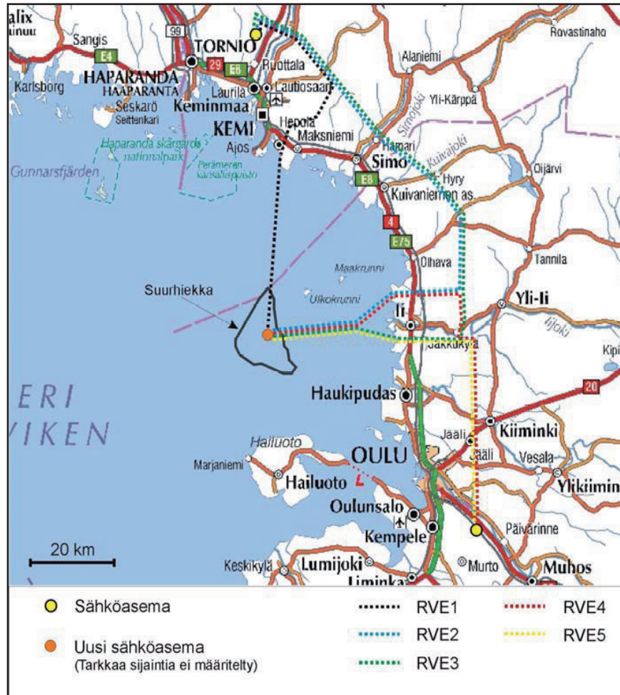
Kuva 2. Suurhiekan vaikutusaluetta sekä kaapeli- ja ilmajohtoreittivaihtoehdot.
