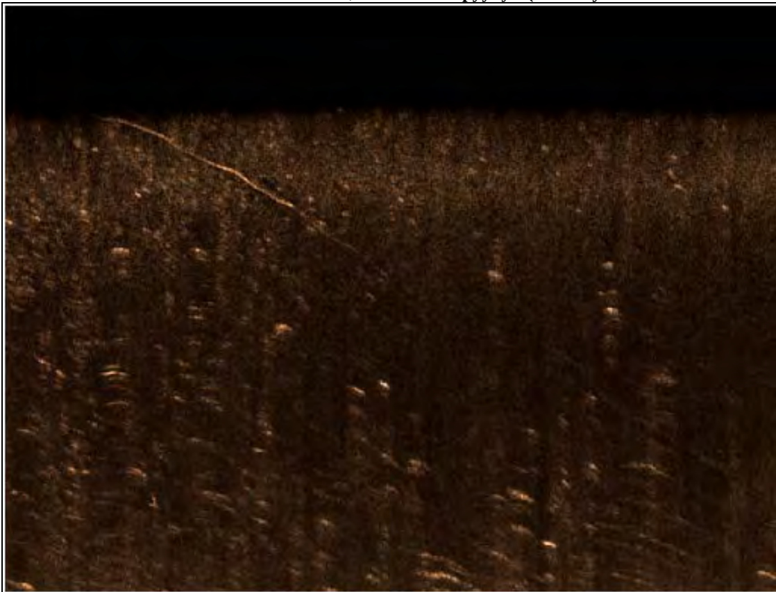
Kuva 118. Olemassa oleva merikaapeli Varessäikkä - Hailuoto. Kaapeli on havaittavissa vain osittain. Kaapeli on pohjakasvillisuuden peitossa tai painunut pohjalietteeseen. (KAT Oy 2010)
