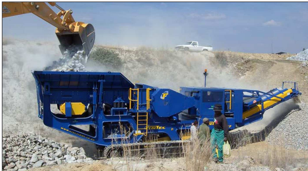
Kuva 10. Betoni-, tiili- ja kivi-jätteen murskaukseen käytettävä leukamurskain 10 .
