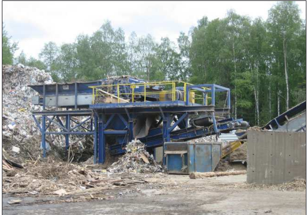
Kuva 8. Puun ja kierrätyspolttoaineen haketukseen käytettävä vasaramurskain.
