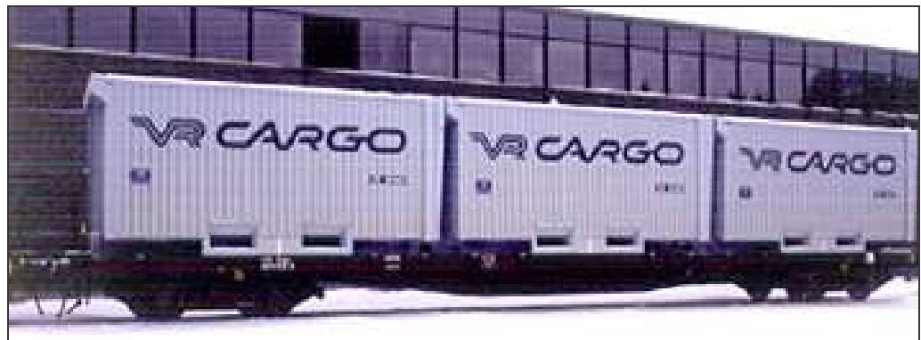
Kuva 17. Hakkeen kuljetukseen käytettävä vaihtokorivaunu 23 .
