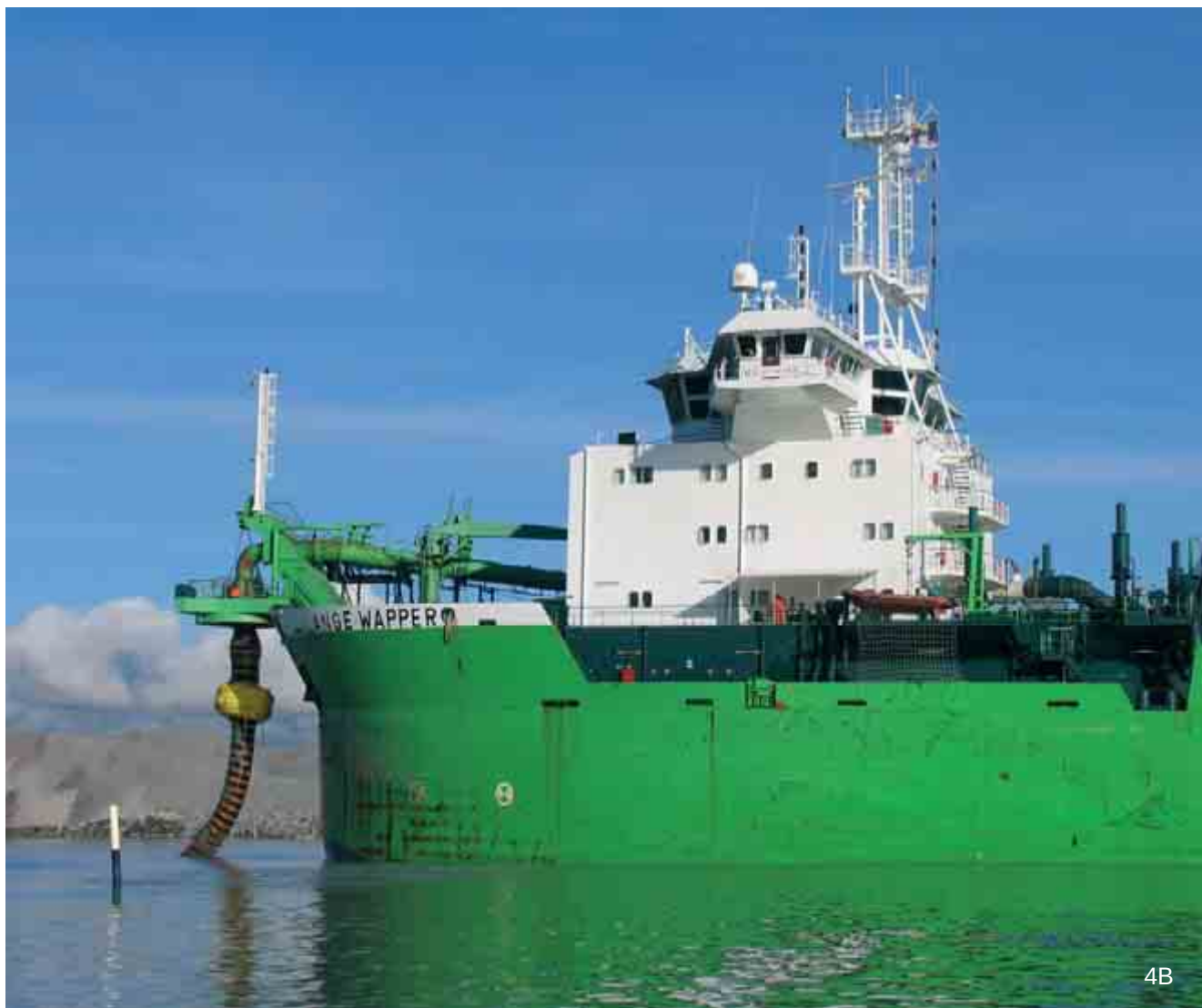
Kuva 4. Maa-ainesten nostoon käytetään imuruoppausaluksia eli hoppereita. 4A: Leikkauskuva imuruoppausaluksesta ( http://www.rohde-nielse.dk/equipment_images ). 4B Helsingin edustalla v. 2004 työskennellyt imuruoppaaja Lange Wapper, jonka vetoisuus on 13 700 m 3 (Morenia Oy:n kuva-aineistoa).
