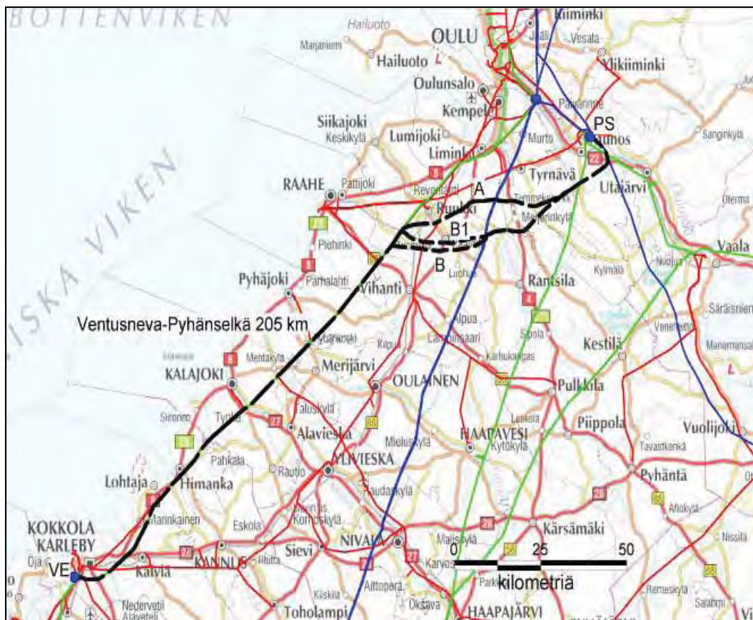
Kuva 1-5 Voimajohtohanke reittivaihtoehtoineen (musta). Sininen 400 kV:n kantaverkko, vihreä 220 kV:n kantaverkko ja punainen 110 kV:n kantaverkko (Fingrid Oy 2009).
