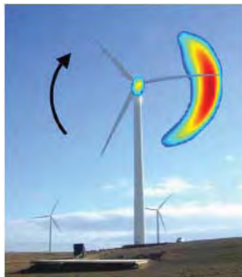
Kuva 7-2a ja b. a) Vaihteistolla varustettu tuulivoimalaitos sekä meluntuoton kannalta keskeiset laitteet ja niiden keskimääräinen osuus äänitehostasosta. b) Akustisella paikannuksella horisontaaliselle mittauspinnalle (noin 150 mikrofoniin muodostama mittauspintaverkko) voidaan paikantaa tuulivoimaloiden suurimmat melulähteet (Carlo Di Napoli 2007).
