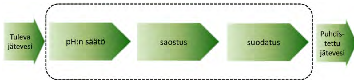
Kuva 5-5. NNH:n jätevesien puhdistusprosessi.
