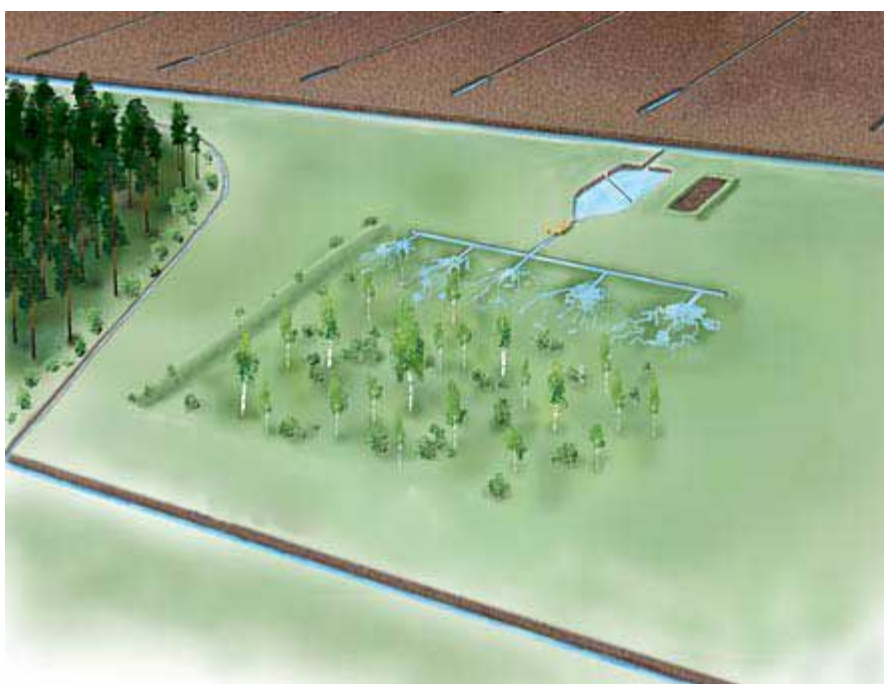
Kuva 5 Periaatekuva pintavalutuskentästä ( www.turveteollisuusliitto.fi / vesiensuojelukortit).
