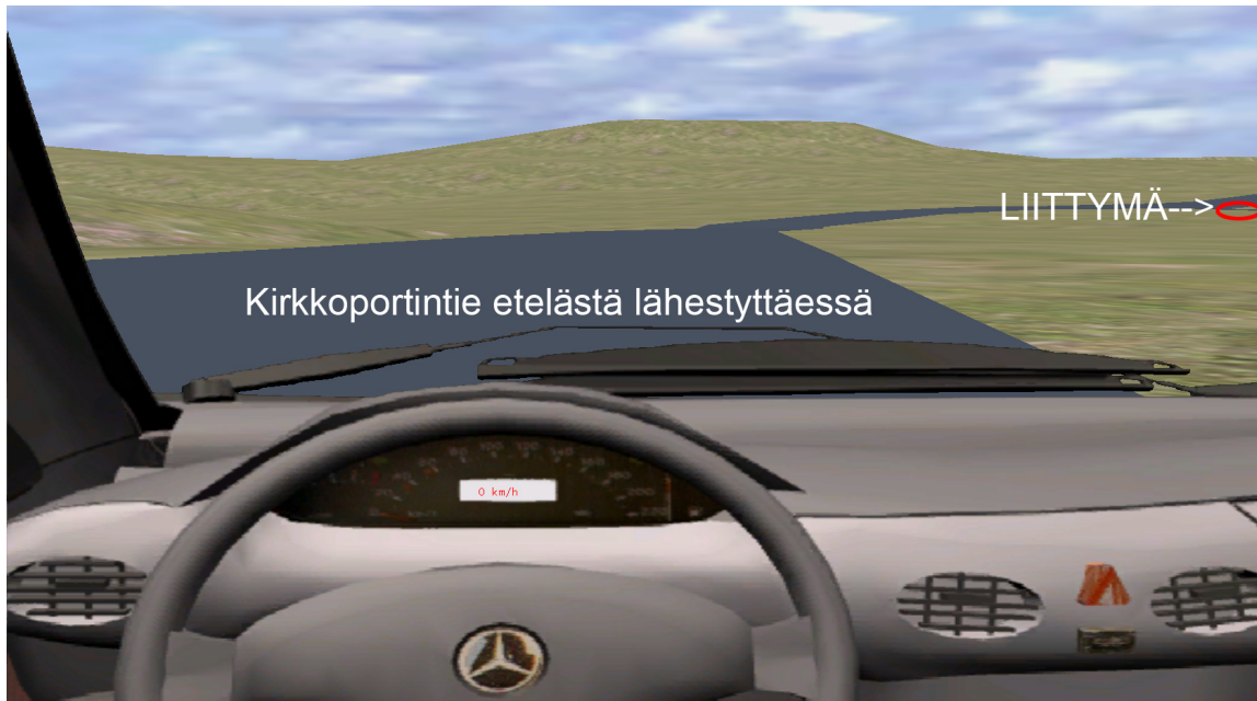
KUVA 33. Liittymisnäkemä Kirkkoportintieltä hankealueen nykyiseen liittymään etelästä tultaessa. Liittymä on korostettu kuvaan punaisella. Liittymisnäkemän parantaminen nykyisestä edellyttää puuston kaatamista, todennäköisesti pientä maansiirtotyötä kohoumien tasoittamiseksi tienpinnan tasoon sekä säännöllistä kasvillisuuden raivaamista.
