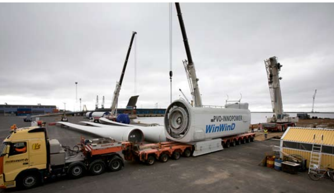
■ Kuva 4-40. Tuulivoimalan kuljettaminen maanteitse toteutetaan erikoiskuljetuksena. Kuva Ajoksen tuulivoimalaitoksen rakentamisesta. Rekan kyydissä WinWindin 3 MW voimala.
