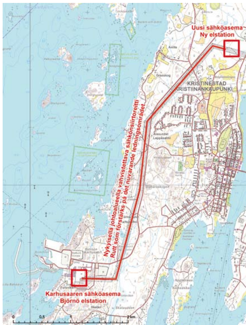
■ Kuva 2-29. Tuulivoimapuiston kytkentä valtakunnanverkkoon.
