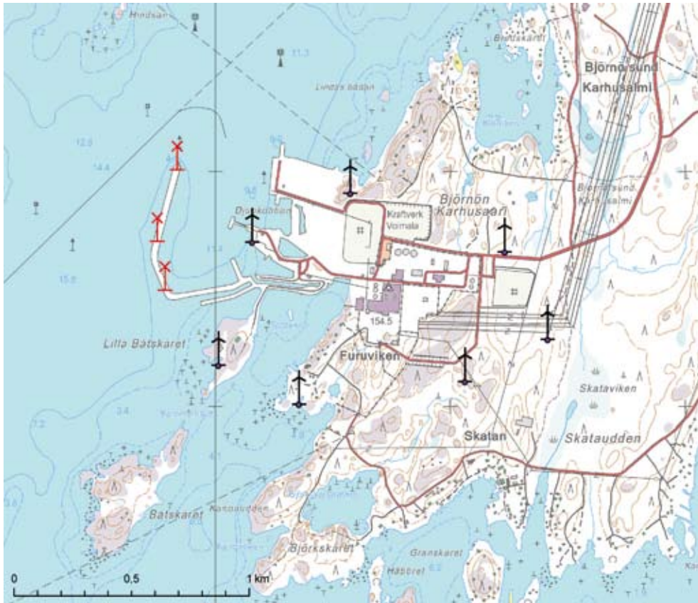
■ Kuva 2-21. Karhusaaren voimalaitosalueelle sijoittuvat tuulivoimalat uuden suunnitelman mukaan.
