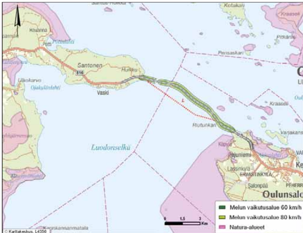
Kuva 7.2. Melun vaikutusalue hankealueella yöaikaan klo 22–07 ohjearvon 40 dB mukaan tilanteissa, joissa ajonopeus pengertiellä on 80 km/h ja 60 km/h, yöajan keskivuorokausiliikenne 120 ajoneuvoa/vrk ja raskaan liikenteen osuus on 6 % liikenteestä.
