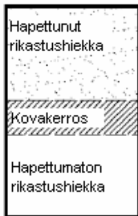
Kuva 23. Rikastushiekan kerrokset (Piia Sassi-Päkkilä 2007).
