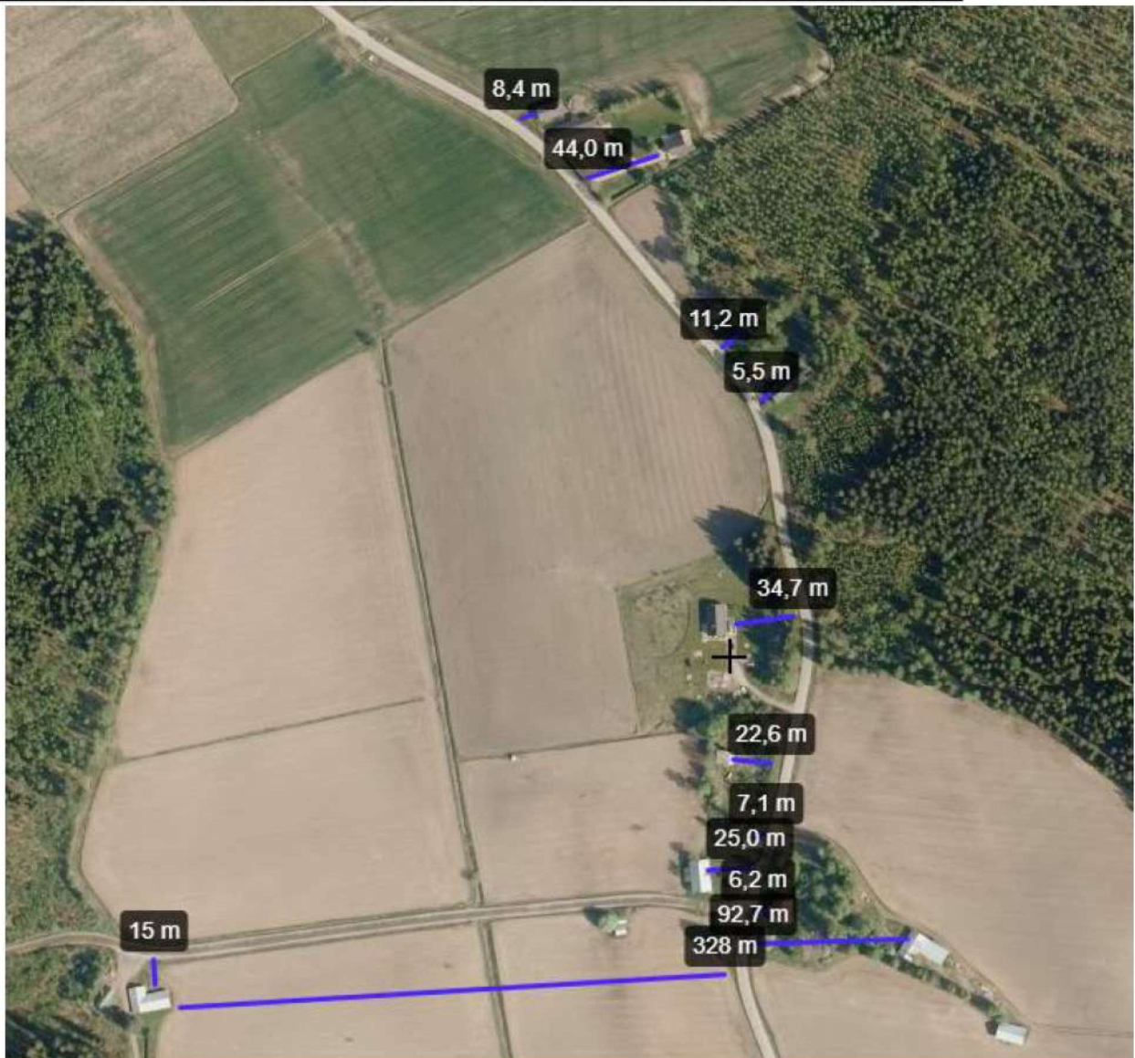
Kuva 27. Hynnänkorventien varrella olevat rakennukset, jotka ovat alttiita liikenteen tärinälle
