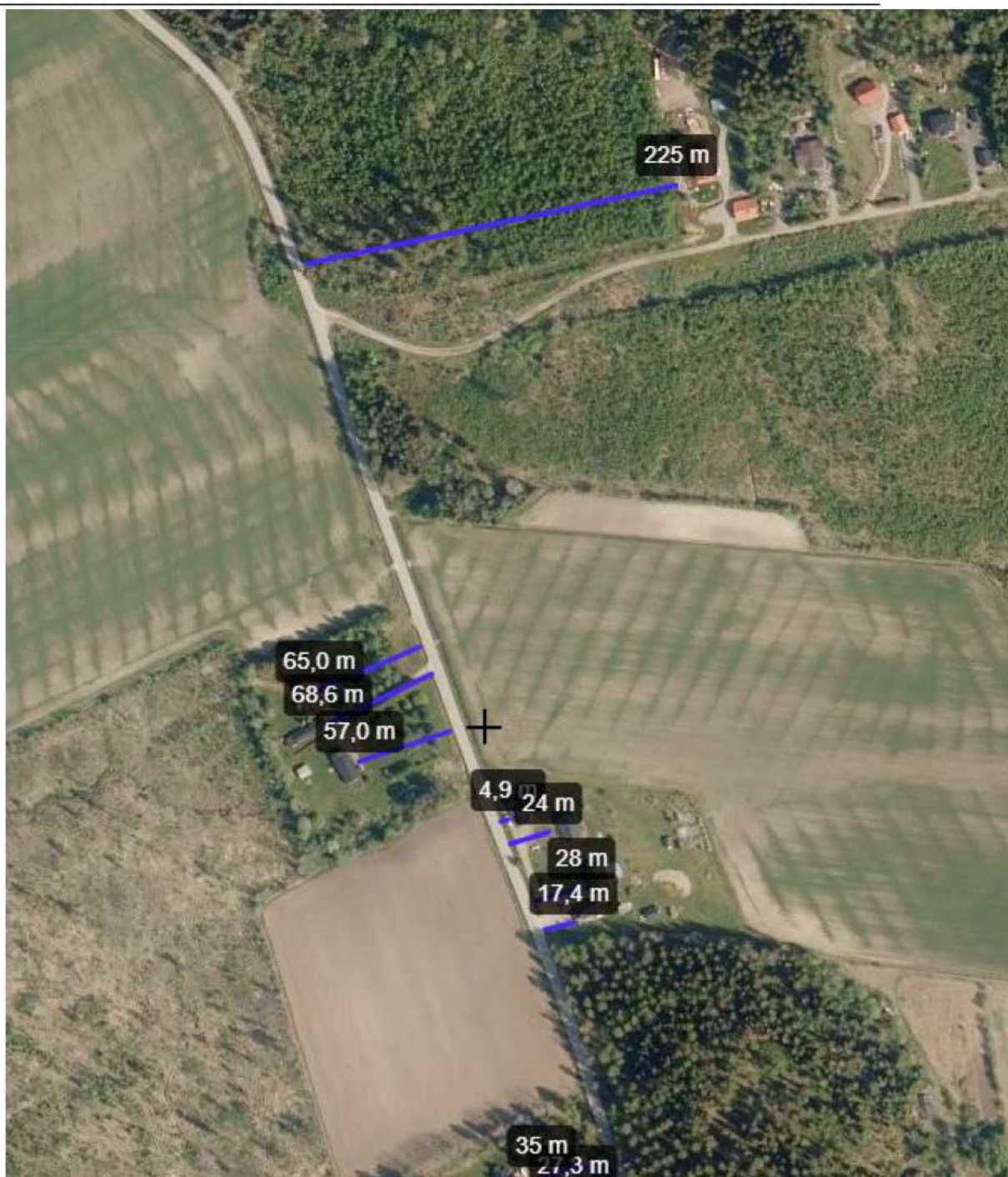
Kuva 25. Hynnänkorventien varrella olevat rakennukset, jotka ovat alttiita liikenteen tärinälle
