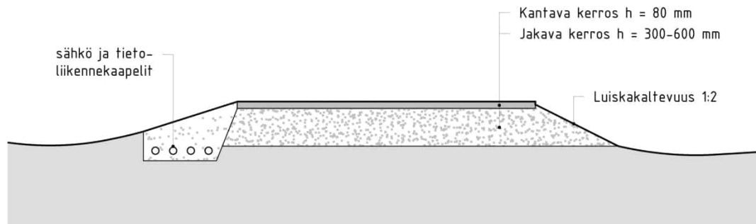
Periaatekuva uuden ja perusparannettavan tien rakenteesta.
