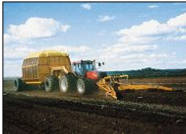
Kuva 4-5. Kokoojavaunumenetelmän karheamisen ja kokoamisen työvaihe. Lähde: Vapo Oy.
