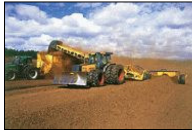
Kuva 4-4. Hakumenetelmän karheamisen (vasen kuva) ja kuormauksen työvaiheet. Lähde: Vapo Oy.
