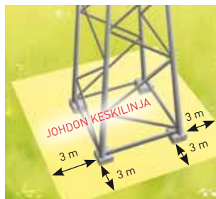
Harustamaton, yksijalkainen pylväs
