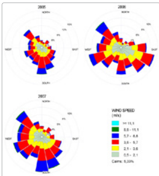
Kuva 7-11. Leviämlaskentojen sääaineiston tuulen suuntien jakaumat (Kuopio).
