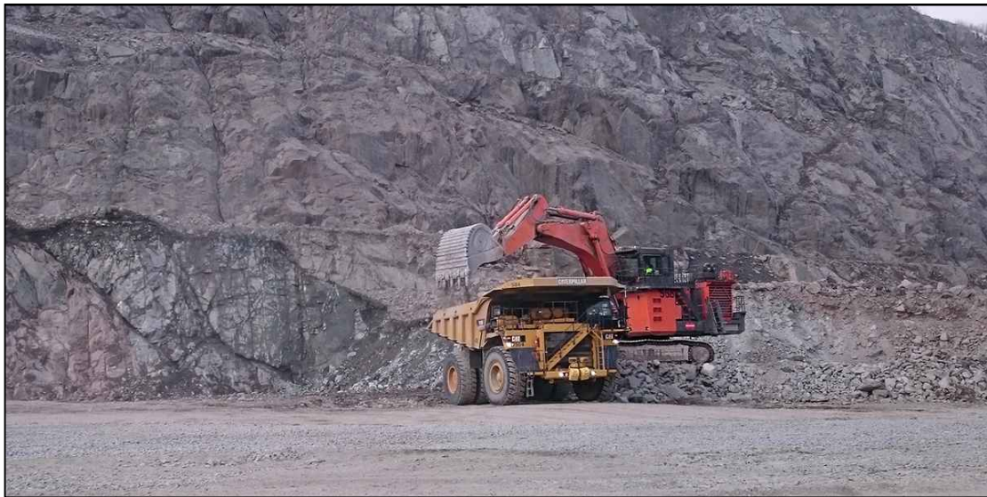
Kuva 2-5. Malmia lastataan louheautoon (Caterpillar 785 D) päälouhoksella. Kuva: Toni Uusimäki.
