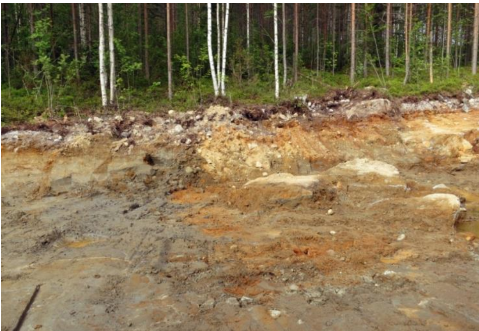
Kuva 10.2. Sama Voimatien uusi linja kuin kuvassa 10.1. Kallion pinta viettää luoteesta kaakkoon (kuvassa oikealta vasemmalle). Oikealla kallion päällä näkyy vain ohut humuskerros, keskellä humuksen alla on hiekkamoreenia ja sen alla on hiesu-siltti-kerros, joka vasemmalle siirryttäessä paksunee.
