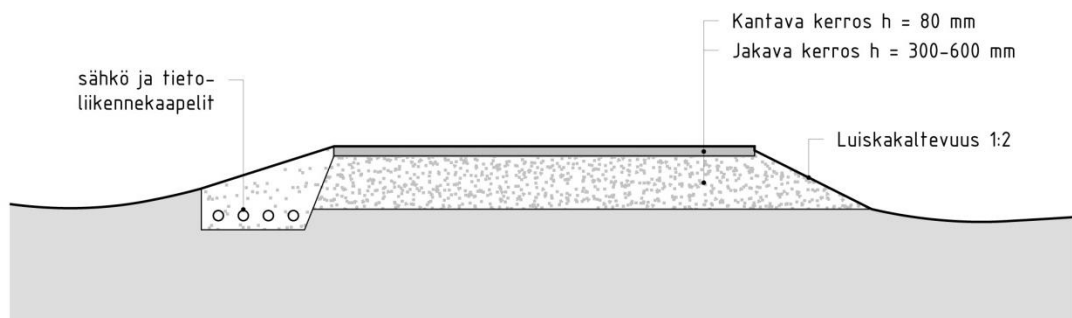
Periaatekuva uuden ja perusparannettavan tien rakenteesta.
