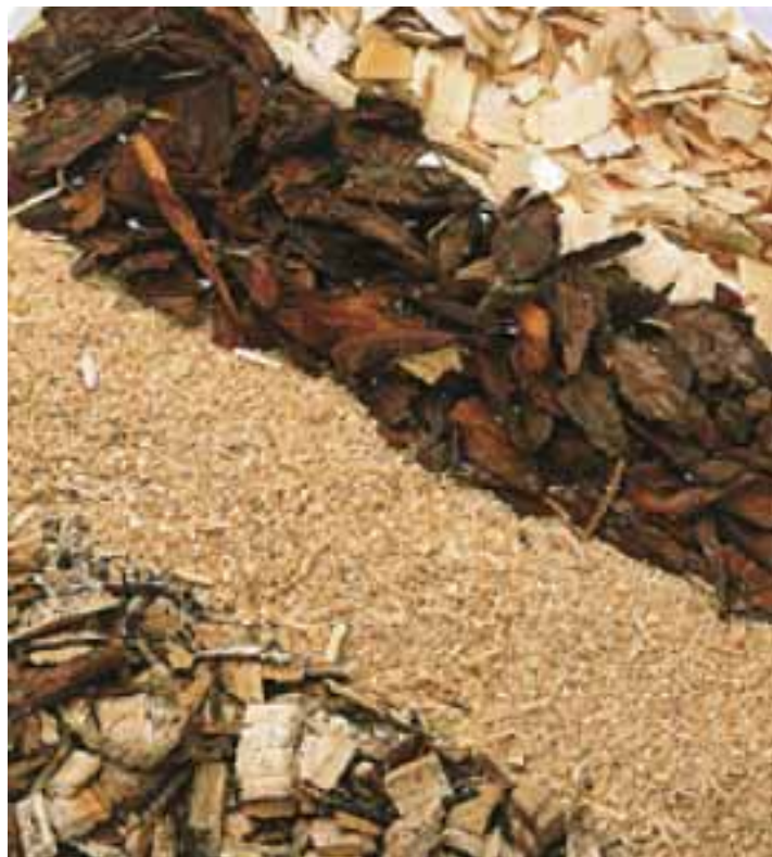
Kuva 10. Puupolttoaine jalostettuna monipolttoainekattilalaitoksen käyttöön soveltuvaksi. Kuva: Vapo Oy.
