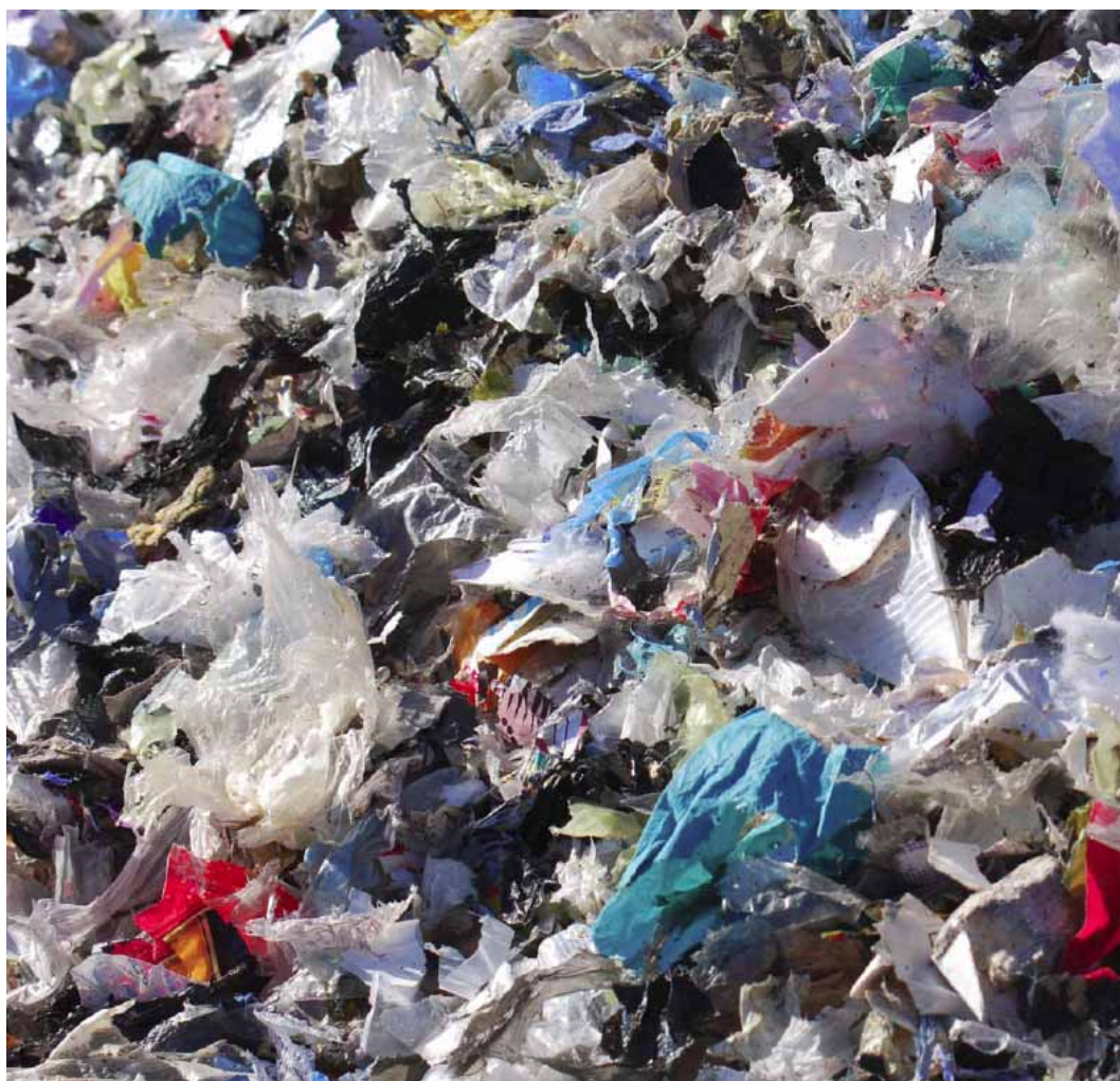
Kuva 11. Kierrätyspolttoaine jalostettuna monipolttoainekattilalaitoksen käyttöön soveltuvaksi. Kuva: Pohjolan Voima Oy.
