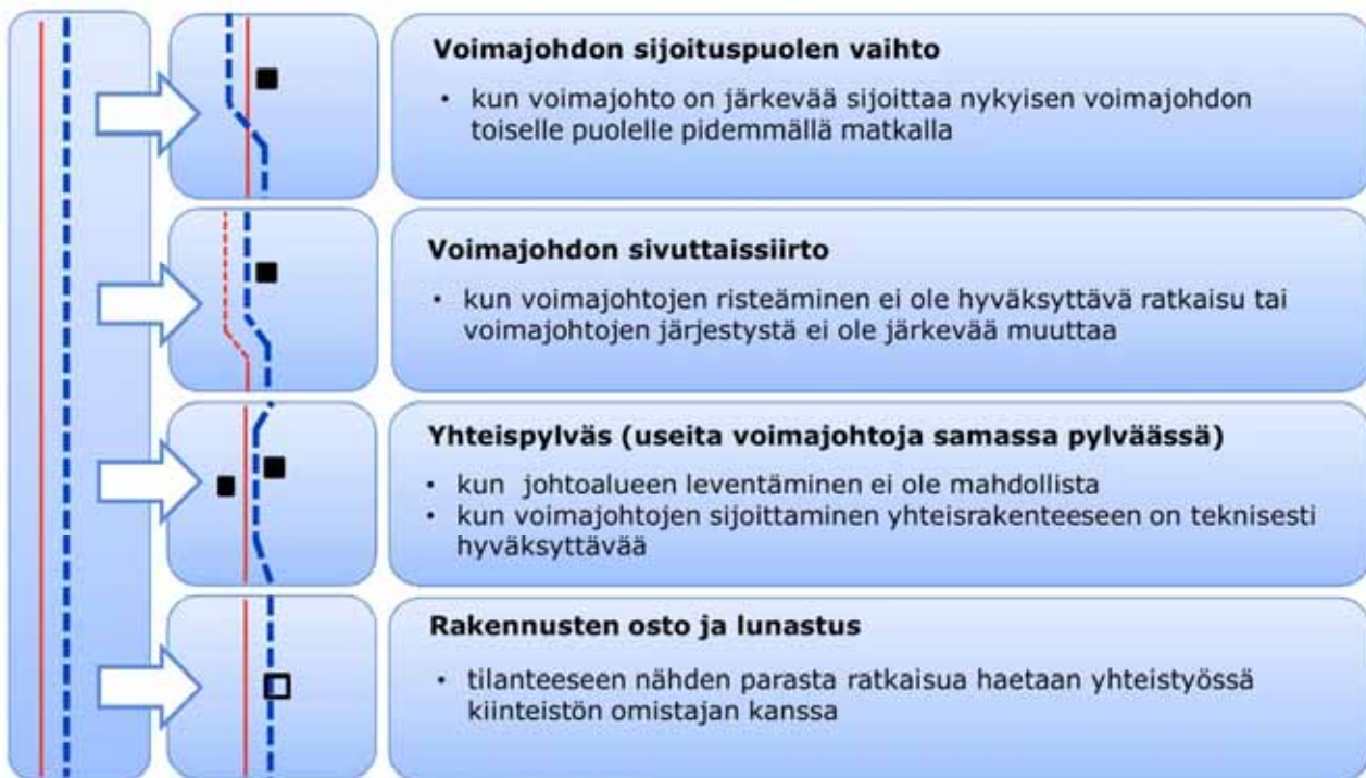
Kuva 6. Periaatteellisia esimerkkejä tavanomaisesta poikkeavista ratkaisuista haasteellisissa suunnittelutilanteissa. Käytettävissä olevat vaihtoehdot ovat aina tapauskohtaisia.
