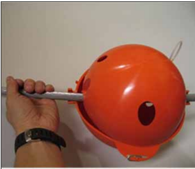
Kuva 77. Lintujen törmäysriskiä voidaan pienentää merkitsemällä johtimet riskialttiissa kohdissa huomiopalloilla.
