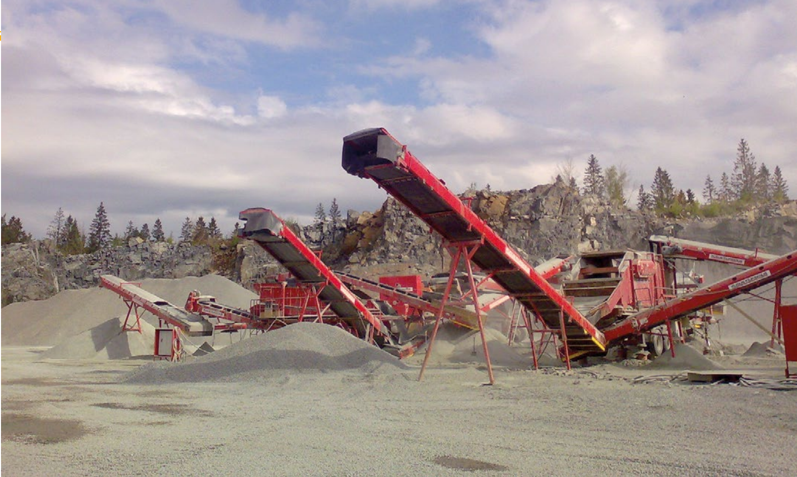
■ Kuva 4-16. Murskauslaitos (Ruduksen Mäntymäen ottoalueelta).
