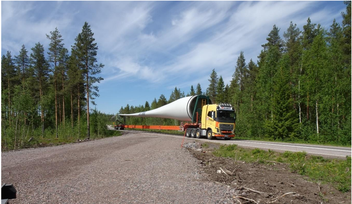
Kuva 20. Tuulivoimalan siipikuljetus. (Kuva J. Silvola, Ramboll)
