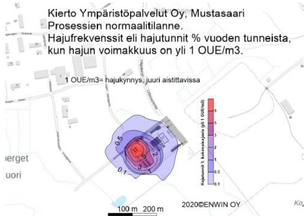
Kuva 9.17. Laitoksen normaalit hajupäästöt. Hajufrekvenssit (%) eli hajutuntien prosentuaalinen osuus vuoden tunteista eri ilmansuunnissa, kun hajutunniksi lasketaan kaikki voimakkuudeltaan yli 1 OUE/m 3 pitoisuudet.
