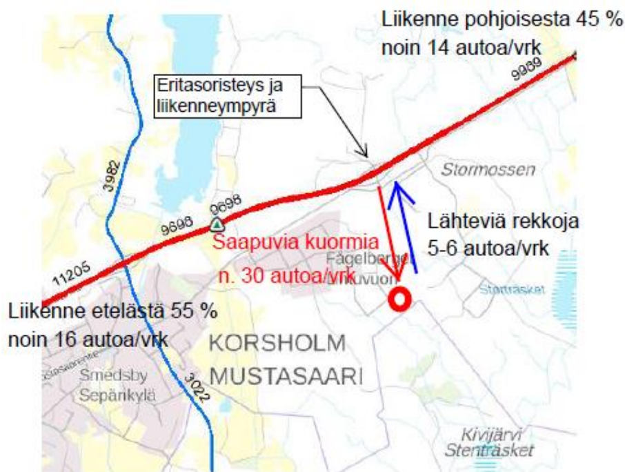
Kuva 9.15. Raskaiden ajoneuvojen reitit laitokselle.
