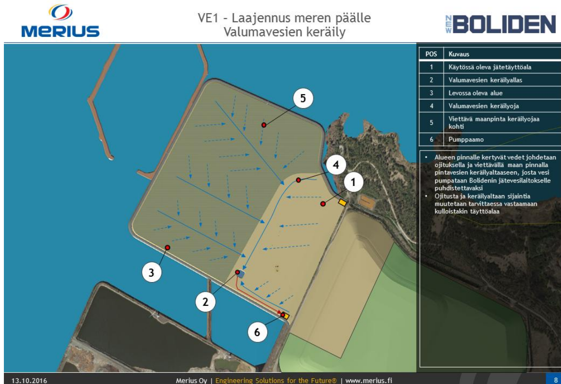
Kuva 3-11. Jätealueen pinnalle kertyvien sadevesien johtaminen.
