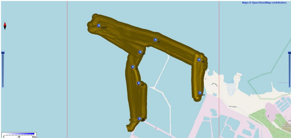
Kuva 5. Mosaiikkikuva viestokaikuluotauksen kattavuudesta tutkittavalla alueella. Purkuputken reittipisteet merkitty sinisillä palloilla. ©Ottomarino Oy
