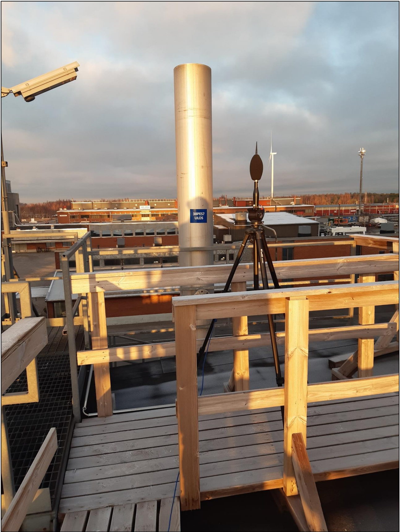
Kuva 3. Pesurin melumittaus tuotantorakennuksen katolla.
