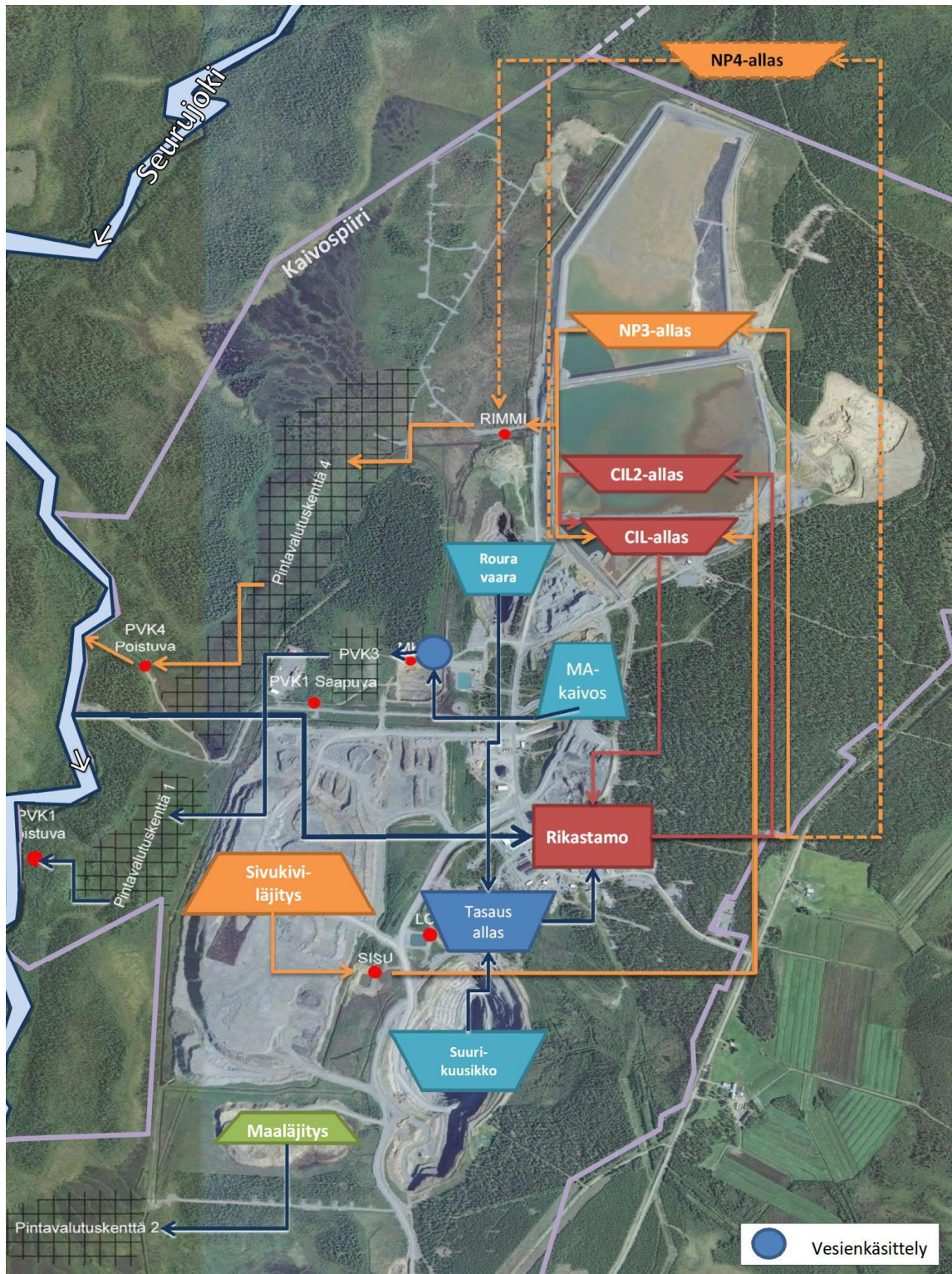
Kuva 5-4. Kittilän kaivoksen yleinen vesikierto. Vesienkäsittely (sininen ympyrä) viittaa maanalaisen kaivoksen vesien selkeytysaltaaseen.
