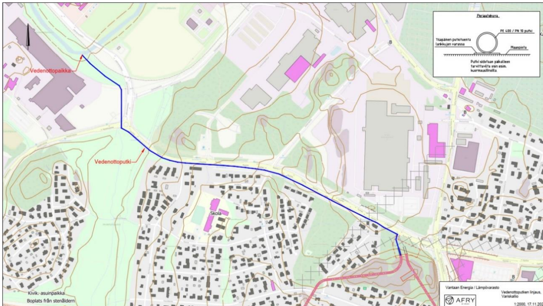
Kuva 3-6. Kausivaraston täyttölinjan alustava reitti Keravajoesta.
