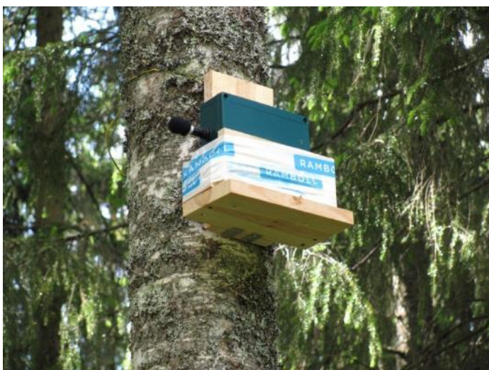
Kuva 113: Passiiviseurantadetektorit SM2BAT kiinnitettynä puun runkoon.
