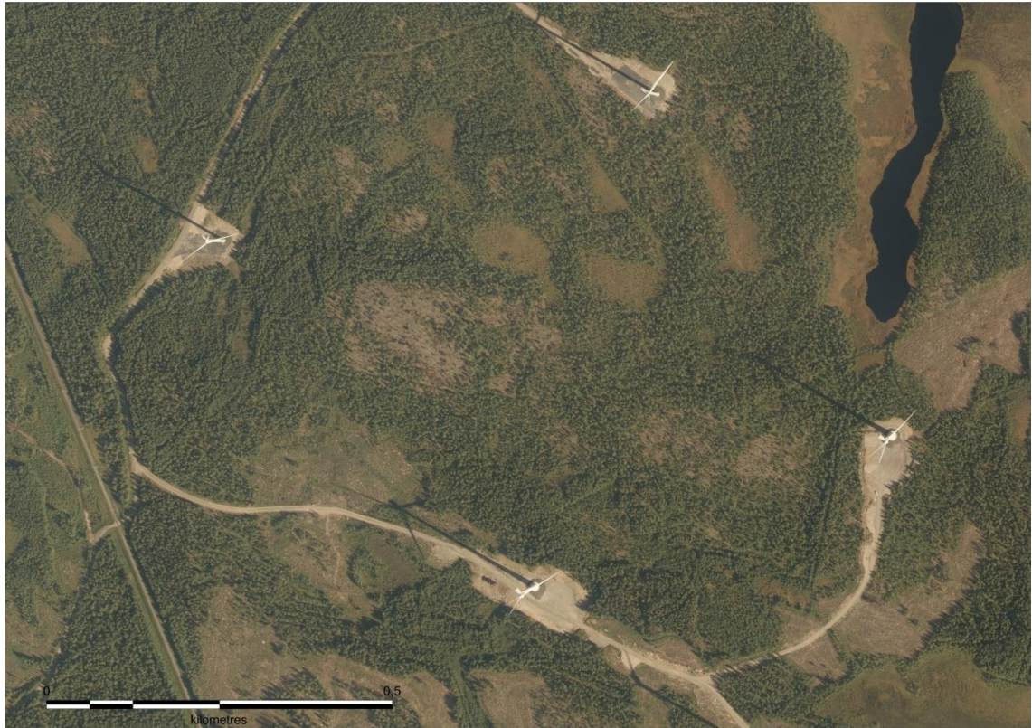
Kuva 2.7. Ilmakuvassa näkyy toiminnassa olevia tuulivoimaloita. Tuulivoimaloita varten on rakennettu huoltotiet ja nostokentät. Tuulivoimaloiden ympäristössä ja välialueilla aikaisempi maankäyttö on säilynyt ennallaan.
