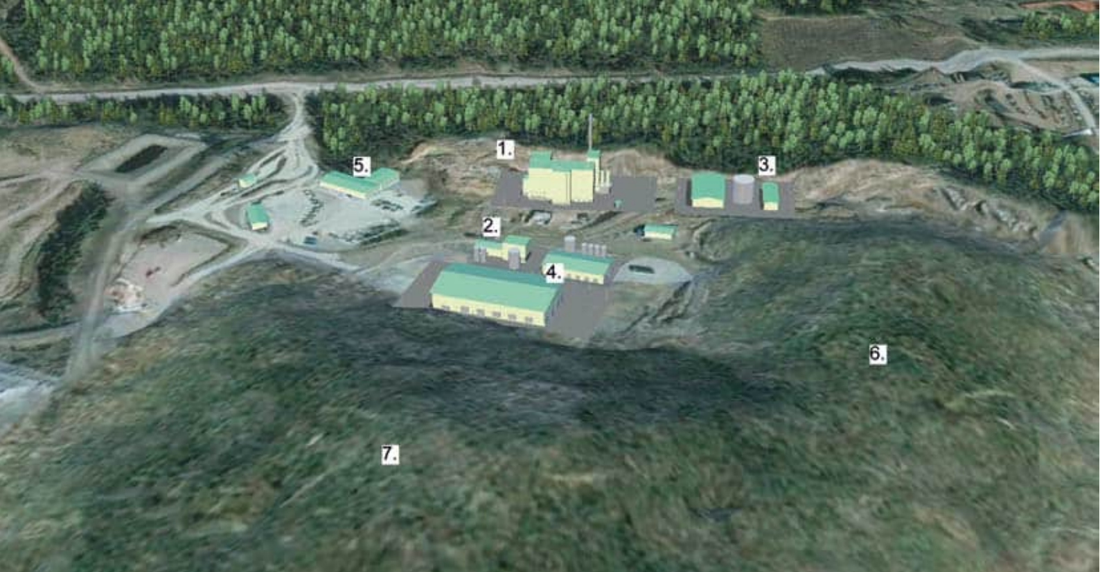
Kuva 5-3 Havainnekuvassa esimerkki laitoksien sijoittumisesta alueella. 1) jätevoimala, 2) etanolilaitos, 3) biokaasulaitos, 4) kierrätyspolttoaineen valmistuslaitos ja kemiallisen dieselin valmistuslaitos, 5) nykyinen toimistorakennus, 6) nykyinen jätetäyttöalue, 7) suunniteltu jätetäyttöalue
