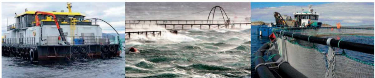
Kuva 4-2. Vasemmalla kuva suuresta ruokintalautasta (joita ei Suomessa toistaiseksi ole käytössä), keskellä kuva tyypillisestä polyeteenikehikkoisesta kasvatustaloksesta ja oikealla kalankasvatuksessa tyypillisestä huoltoaluksesta. (alkuperäinen kuva (Akvagroupp))
