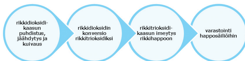
Kuva 3. Rikkihappotehtaan prosessivaiheet
