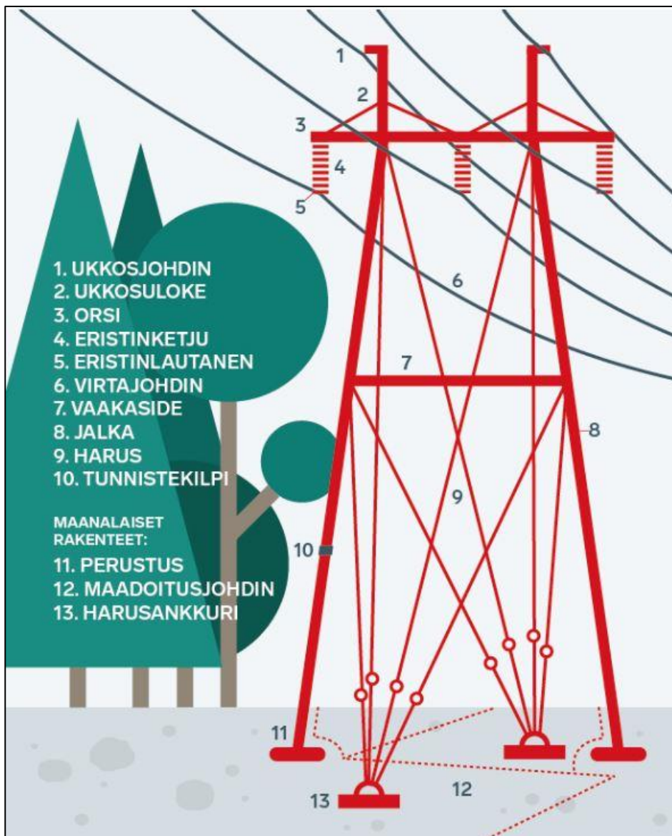
Kuva 12. Pylvään osat (Fingrid, 2024a).
