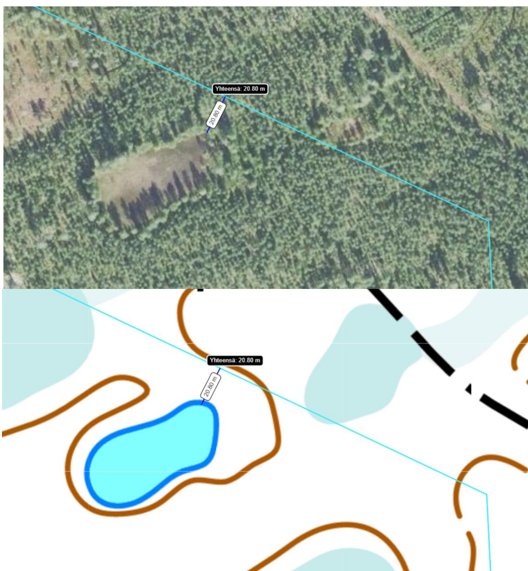
Kuva 8-6. Suunnitellun ilmajohdon sijainti suhteessa Suksisuonmetsän metsälammen, jonka luonnontilan vaarantaminen on lailla kielletty. Johtoaukean ollessa 42 metriä, se tulisi ylittämään lampeen (keskilinjasta 21 m lammen suuntaan). Toimenpiteiden osalta ei voida pitäytyä 30 m suojaetäisyydessä, ellei sijoittelua muuteta etäämmäs lammesta. Yllä ilmaortokuvana ja alla maastokartalla esitettyinä.
