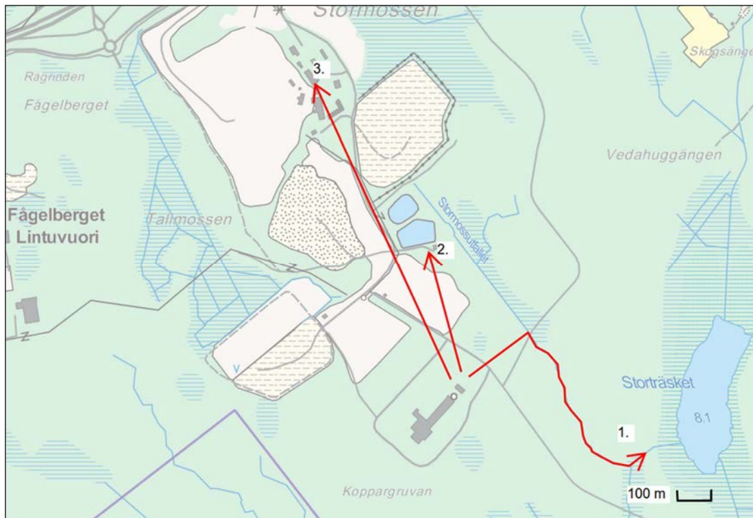
Kuva 4-1. Lämmöntalteenoton lauhteen purkupaikat.
