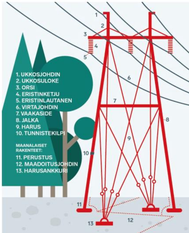
Kuva 3-2. Voimajohdon osat (Fingrid Oyj 2020).
