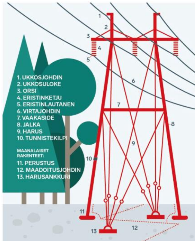
Kuva 3-5. Voimajohdon osat (Fingrid Oyj 2020).
