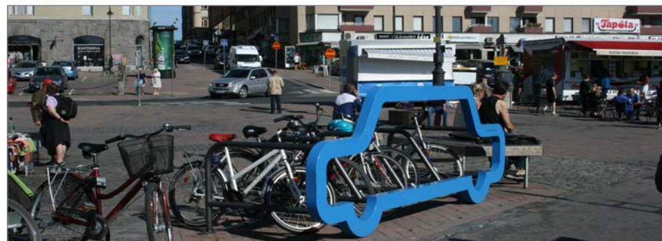
Cyclehoopin pyöräteline. Telineet ovat siirrettäviä ja tarvitsevat noin yhden henkilöauton verran parkkitilaa. Telineeseen mahtuu n. 10 pyörää.
