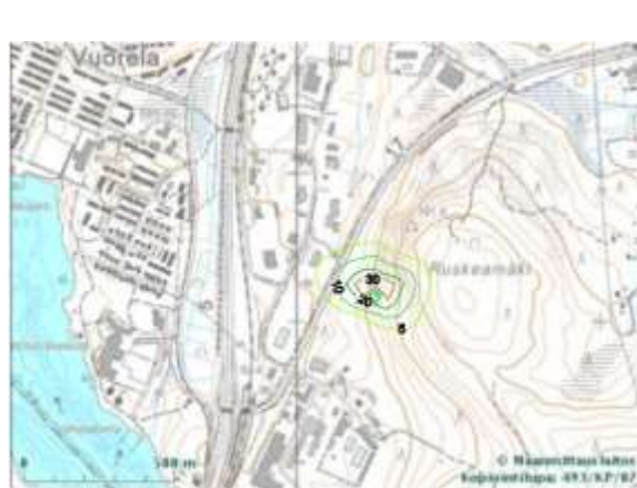
Kuva 9.7/8. Toiminnan aiheuttamat hengitettävien hiukkasten (PM10) a) vuorokausipitoisuudet ja b) vuosipitoisuudet toiminta-alueen ympäristössä v. 2005 sääaineistolla.
