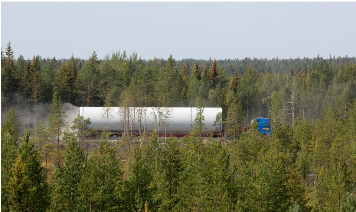
Kuva 4.19 Tuulivoimalan torniosien kuljetusta (FCG Finnish Consulting Group Oy).
