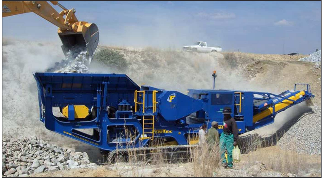
Kuva 8. Betoni-, tiili- ja kivi-jätteen murskaukseen käytettävä leukamurskain 6 .
