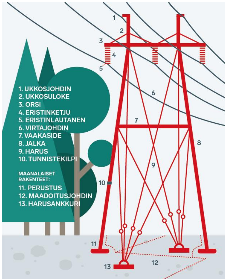
Kuva 2-13. Harustettu voimajohtopylväs (Fingrid 2025).
