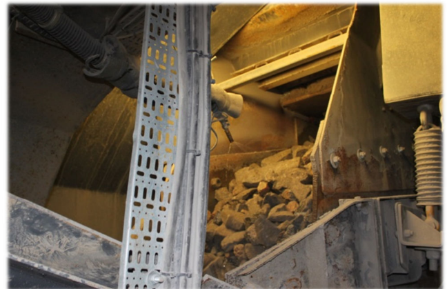
Kuvat 16 ja 17. Tunnelisyöttimen kiviaineskasa ja tunnelisyöttimen kastelujärjestelmä.
