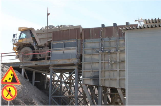
Kuvat 13 ja 14. Syötin, primäärilinjain koteloidut murskaimet ja seula sekä koteloidut kuljettimet. Kuvassa näkyvissä syöttimen korkeapainekastelujärjestelmä ja korotetut laidat ja kuorman tyhjentämistä odottava kiviauto.
