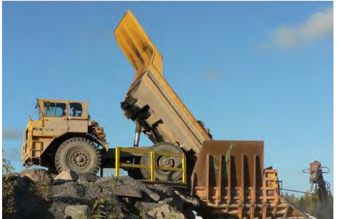
Kuva 3.7. Louheen kippaus murskauslaitokseen.
