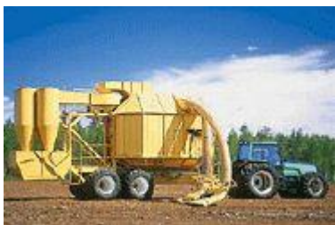
Kuva 5-6. Kokoaminen imuvaunulla. Lähde: Vapo Oy
