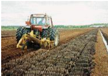
Kuva 5-5. Palaturpeen nosto. Lähde: Vapo Oy
