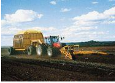
Kuva 5-4. Kokoojavaunumenetelmän karheamisen ja kokoamisen työvaihe. Lähde: Vapo Oy
