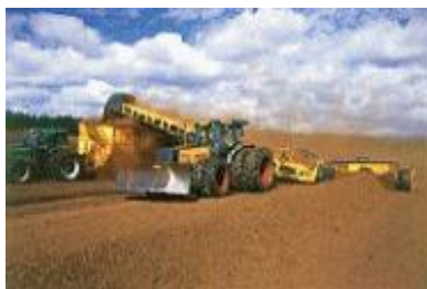
Kuva 5-3. Hakumenetelmän karheamisen (vasen kuva) ja kuormauksen työvaiheet. Lähde: Vapo Oy
