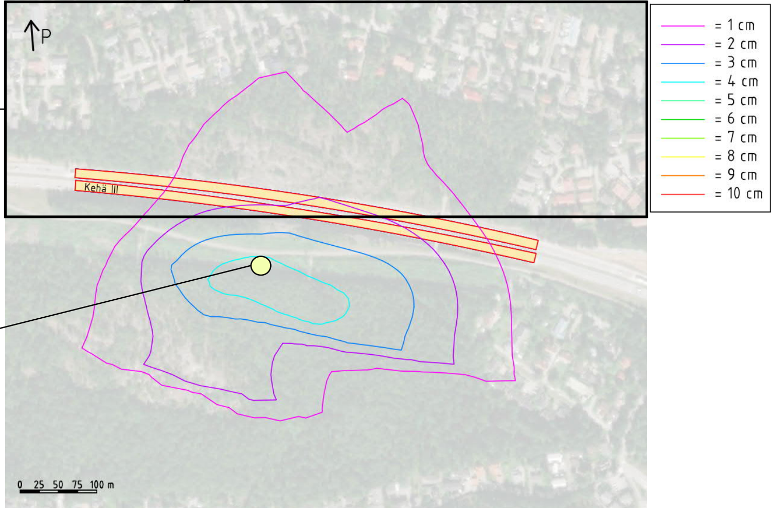
Kuva L3. Kevään 2021 simulointituloksien havainnekuva louhintojen aiheuttamista siirtymistä maanpinnalla
