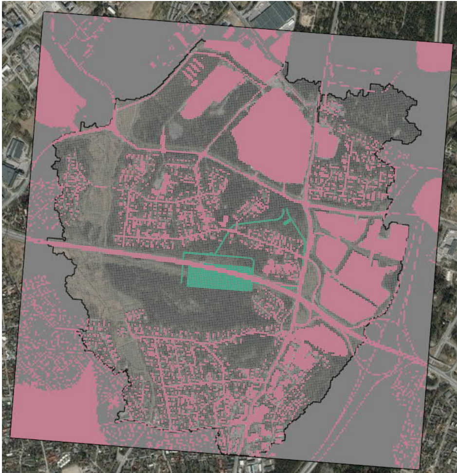
Kuva 4-4. Hilaverkon solut, joiden kautta ei muodostu pohjavettä (punainen). Mallin inaktiivinen alue harmaalla (ei muodostu pohjavettä, eikä mukana mallin laskennassa).
