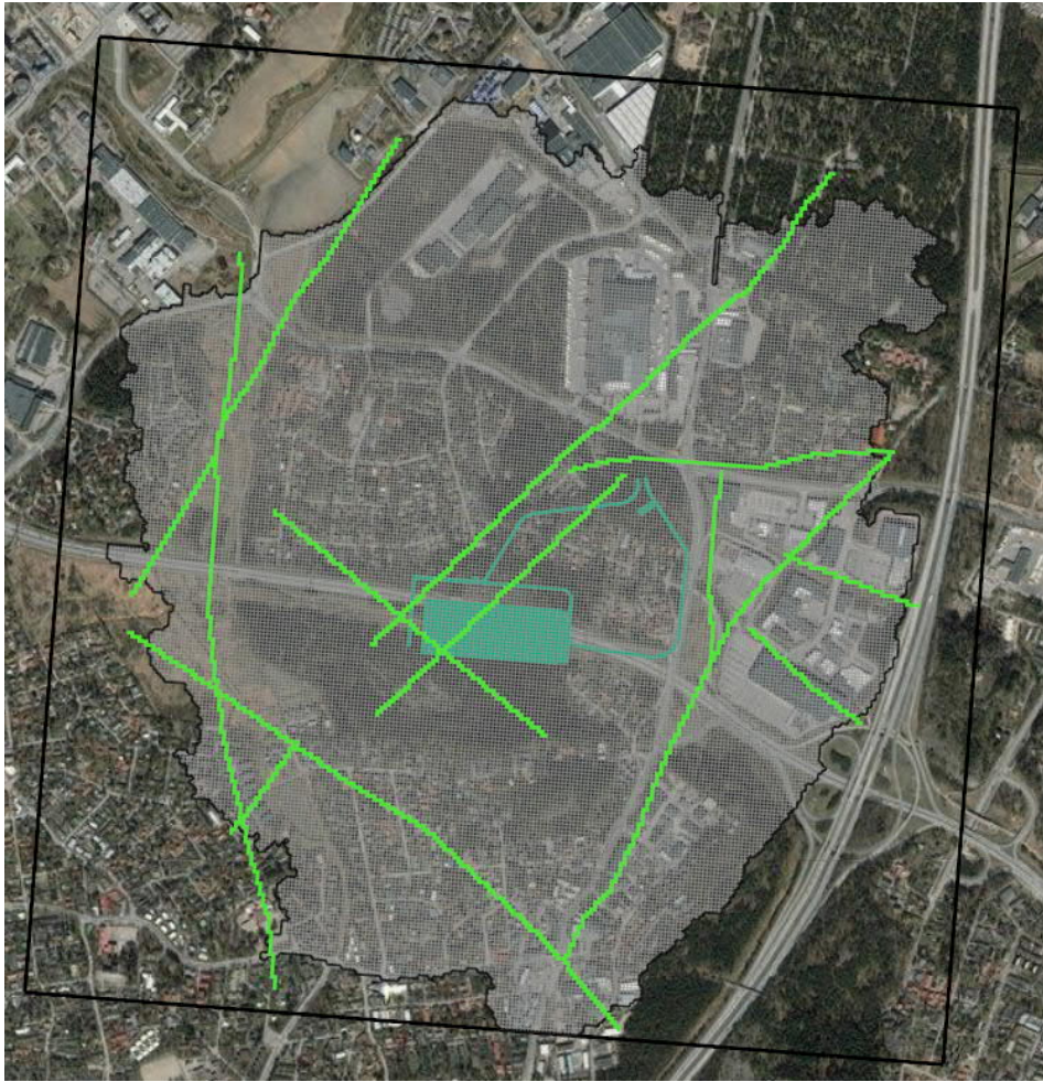
Kuva 4-3. Kallioperän tulkittuja heikkousvyöhykkeitä kuvaavat hilaverkon solut (vihreällä).
