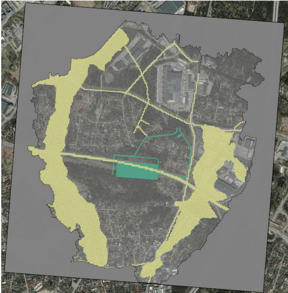
Kuva 4-5. Virtausmallin purkusolut (keltaisella).
